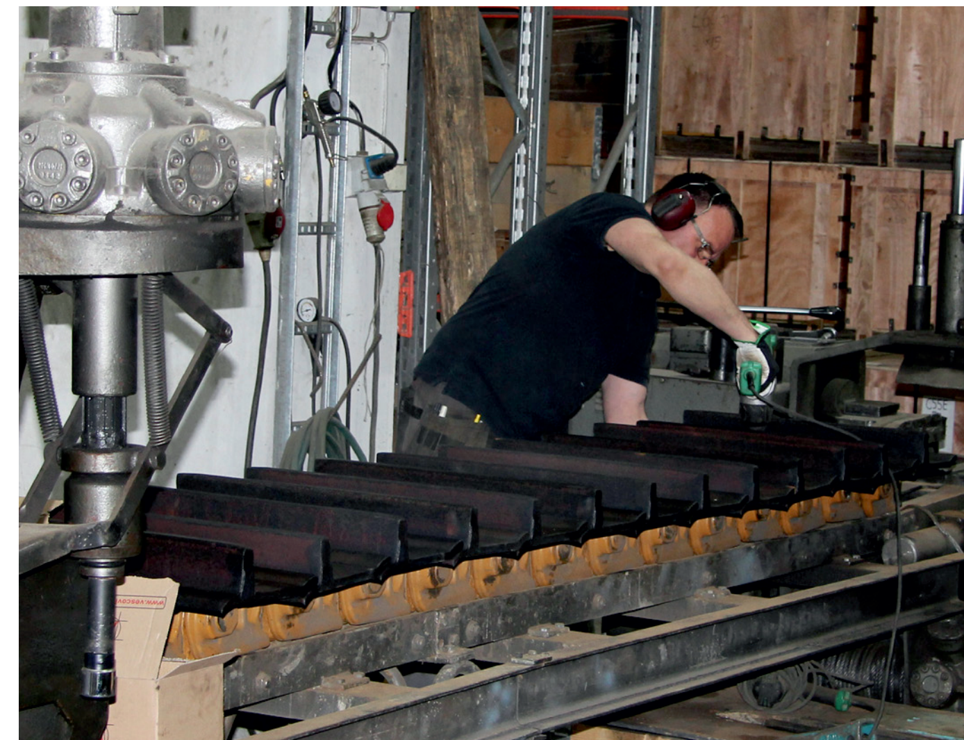
Montaż łańcuchów z płytkami odbywa się w hali aby zapewnić odpowiednią jakość kompletnej gąsienicy.
